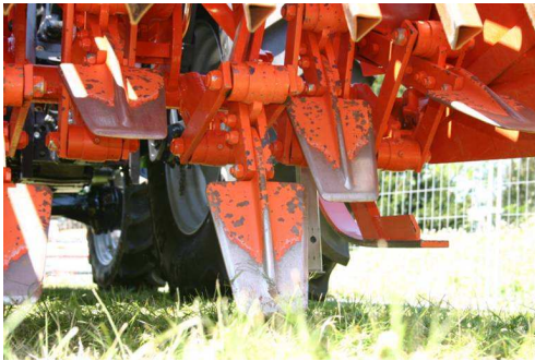
Werkzeuge von stechend arbeitenden Spatenmaschinen
