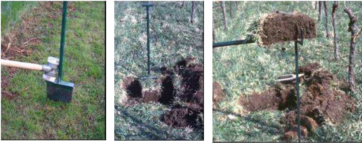
Entnahme einer ungestörten Probe im Rahmen der Spatenprobe nach Görbing
