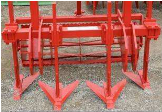
Grubber mit breiten Gänsefußscharen und nachlaufender Krümelwalze, auch zur Unterkrumenlockerung geeignet.
