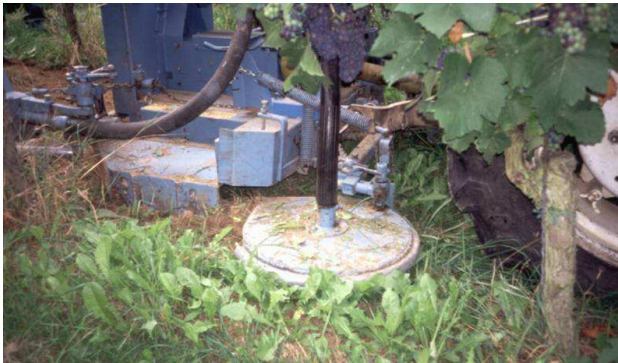
Geräte zum Einkürzen des Begrünungsbewuchses unter der Zeile - Schwenkarmmulcher (li), Zeilenputzer (re).
