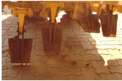
Werkzeuge von stechend arbeitenden Spatenmaschinen
