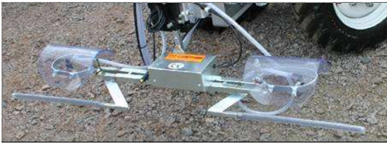
Chemische Unkrautbekämpfung unter der Zeile – Bandbehandlung mit Herbiziden
