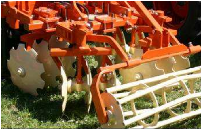
Mehrfach verstellbare zwei-zeilige Scheibenegge mit gezackten Scheiben und nachlaufender Krümelwalze (Stabwalze).
